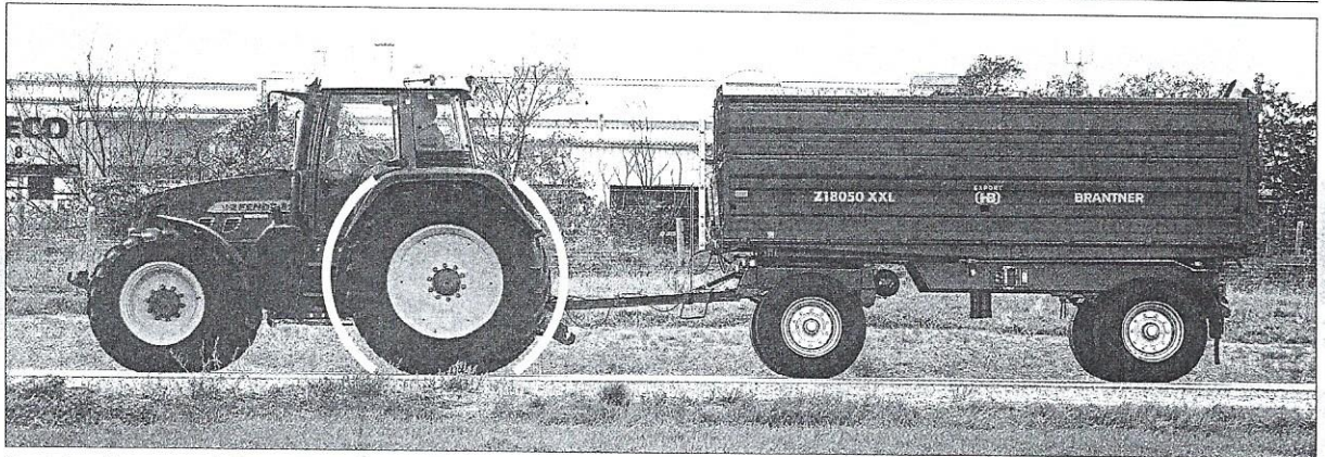
Traktoreigengewicht x 2 = Anhänger-gesamtgewicht (max. 6 t)
